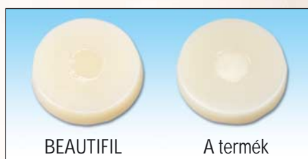
A belső rész polimerizálás előtt, a külső polimerizálás után
